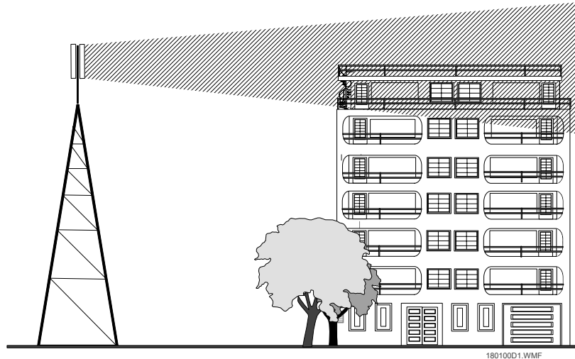
Figure 15 : Bâtiment situé dans le faisceau
